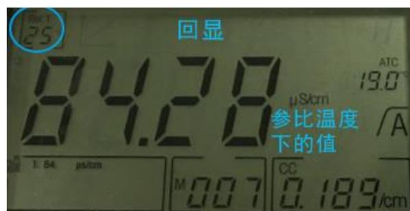
测样品的电导率的值，是显示经过温度补偿的电导率值（取决于是否设置过温度补偿）
